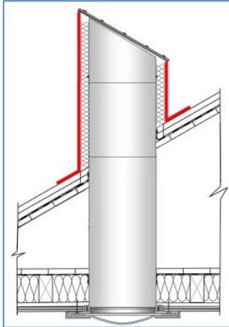
LKM45A-DVI verläuft nur durch den Dachaufbau →
