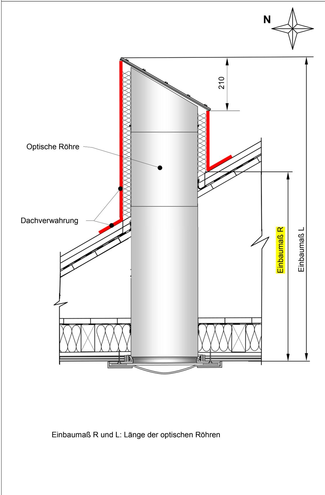
Schnitt Gesamtsystem: Raumdecke parallel zum Dach mit Winkelstück
