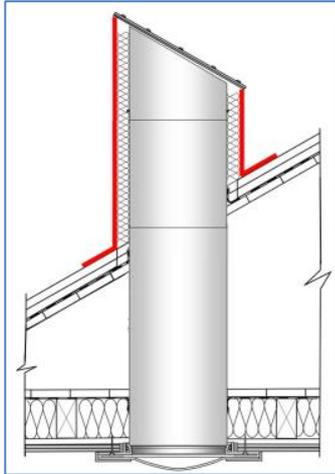
LKM30A-DVI verläuft nur durch den Dachaufbau →
